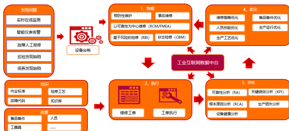
工业互联网数据中台架构图
